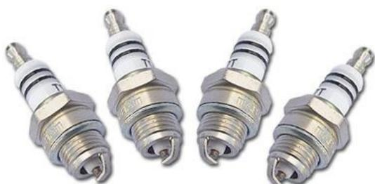
Свечи не должны содержать нагара. Необходимый свече зазор (0,5мм) выставляется, отогнув/подогнув её контакты. Расстояние между контактами прерывателя в норме от 0,4 до 0,6
