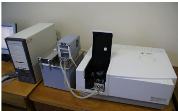
Рис. 21. Спектрофлюорофотометр RF-5301PC (Shimadzu) забезпечує проведення високочутливого спектрального аналізу випромінювання зразків.
