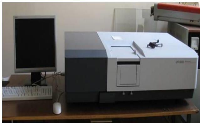
Рис. 20. Спектрофотометр Shimadzu UV3600 (для вимірювання спектрів поглинання рідких та твердотільних зразків в УФ, видимій і ближній ІЧ областях спектру (185-3300 нм)).
