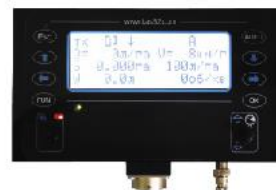
Комп'ютер контролю вливу з BPRS і GPS
