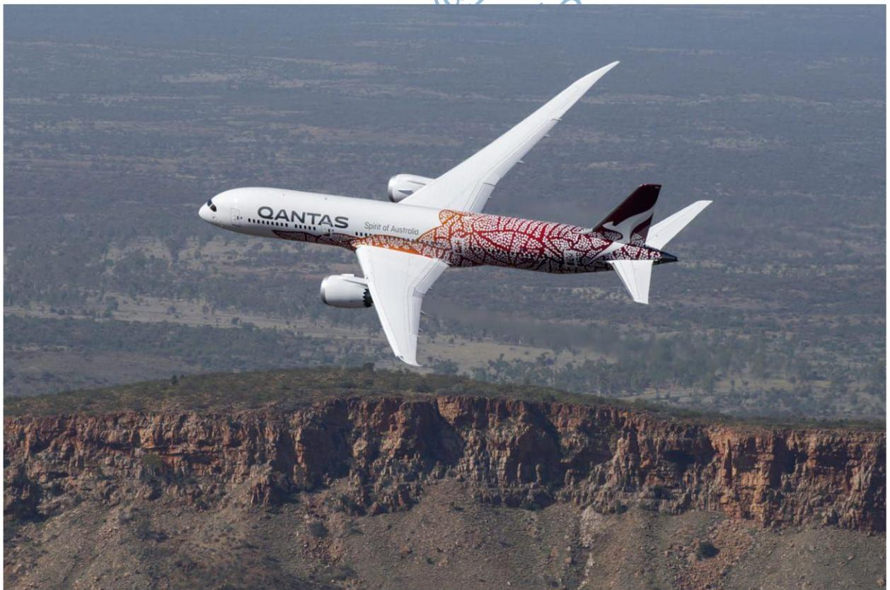
При производстве около половины элементов его фюзеляжа использованы композиты, поэтому он стал легче и прочнее, чем самолеты из алюминия. Двигатели Дженерал Электрик и Роллс-Ройс стали менее шумными и более экономичными. Высота окон этого самолета – рекордная среди всех коммерческих самолетов, 46 см, с регулируемым затемнением. Давление в салоне соответствует высоте 1 800 метров, а не 2 400, как в алюминиевых самолетах. Пассажиры могут пользоваться широкополосным интернетом.
