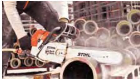
вивает полную мощность с первого реза, предварительная заточка сегментов при резке не требуется. Изготовленная фирмой STIHL цепь имеет ведущие звенья с выступом и алмазный сегмент на каждом звене. Конструкция цепи и ведущее звено с выступом обеспечивают, кроме прочего, тихую работу с низким уровнем вибраций.
