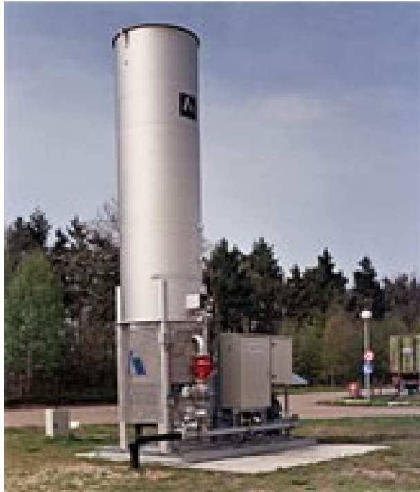
HOFGAS® - Ready – факел – утилізатор звалищного газу
