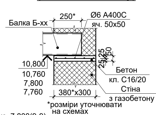
Деталь влаштування балок сходової клітини (стіна з газобетону)
