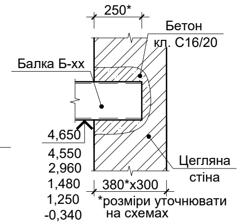
Деталь влаштування балок сходової клітини (цегляна стіна)
