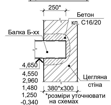
Деталь влаштування балок сходової клітини (цегляна стіна)
