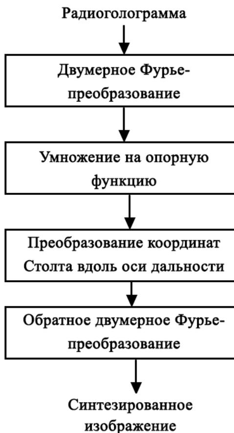
Рис. 1.15 Блок-схема « $\omega$ -K» алгоритма синтеза изображения
