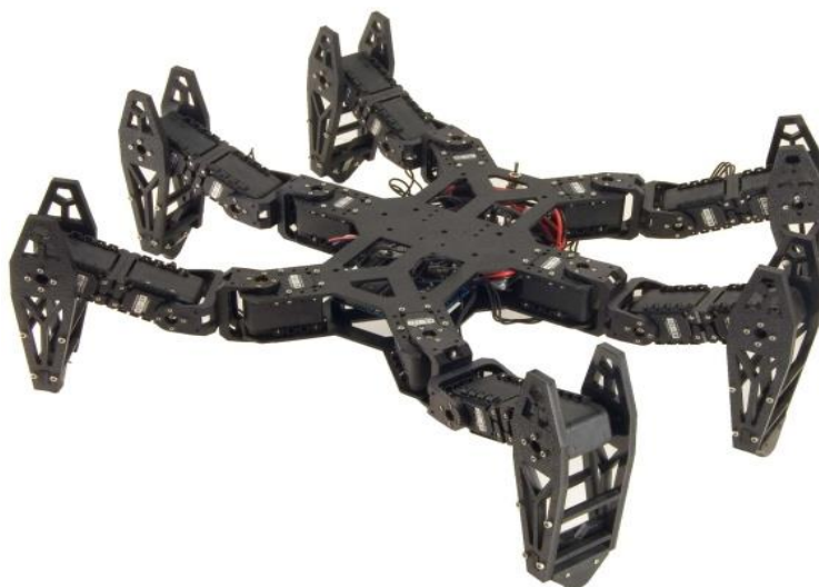
Рис. 2.1. Приклад платформи "Гексапод"
