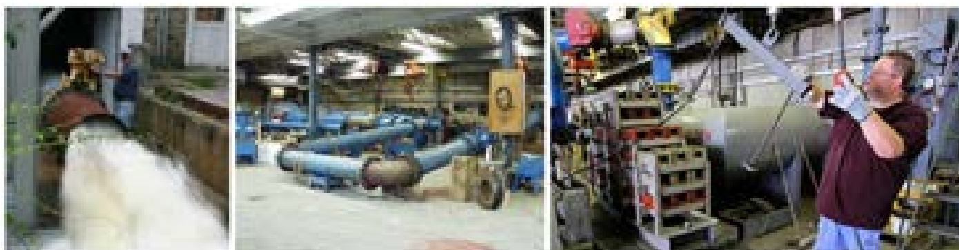
Рисунок 21 – стендовая калибровка поточных расходомеров в авторизованном центре Alden (США)
