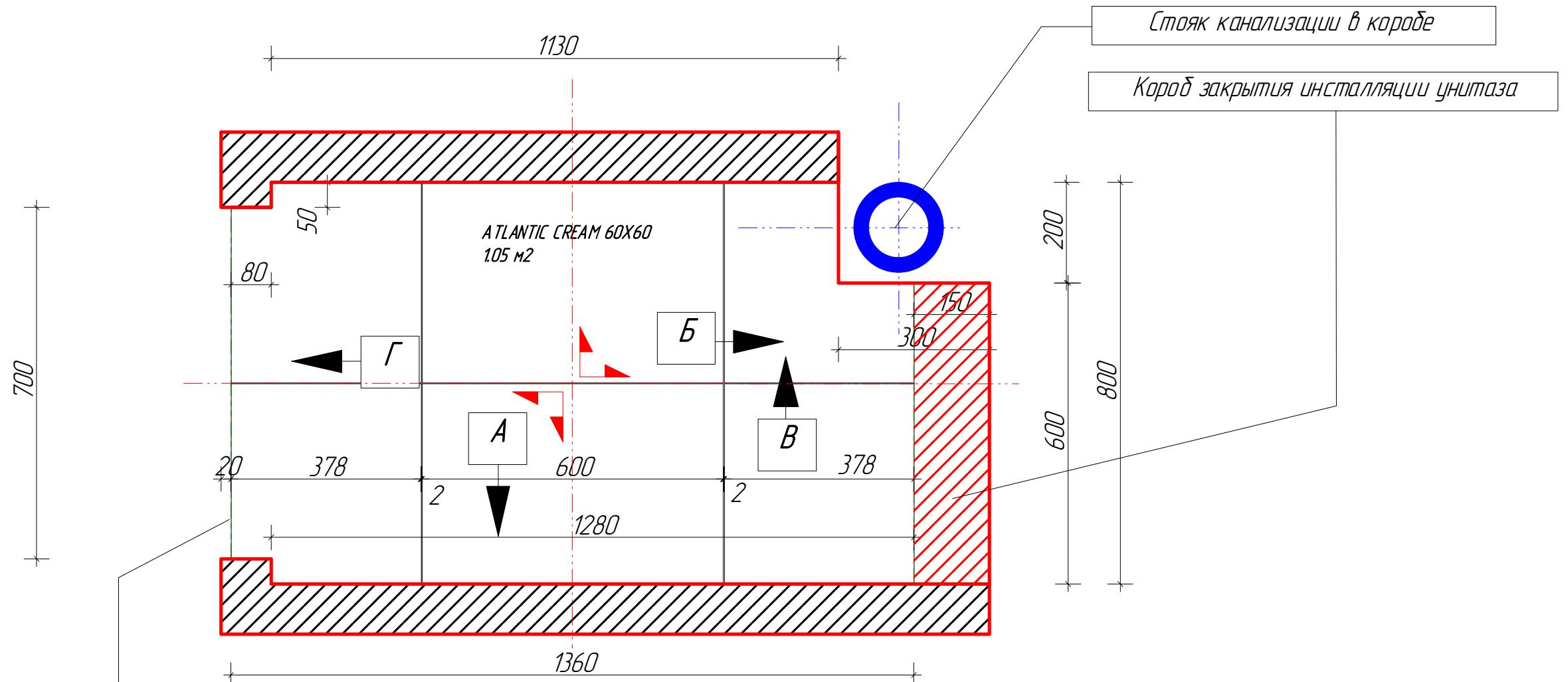
Стыковку покрытий выполнить в соответствии с перекрытием дверным полотном в закрытом состоянии.
