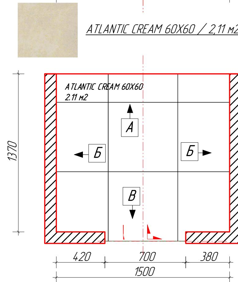
Стык покрытий устроить под дверным полотном в закрытом положении.
