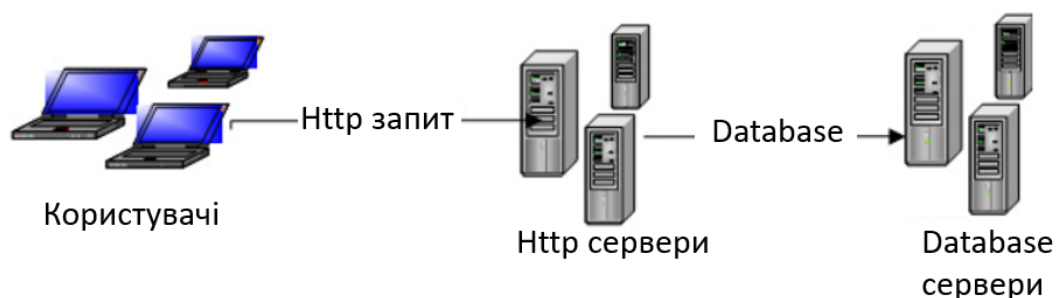
Рисунок 2.10 – схема роботи веб-додатку
