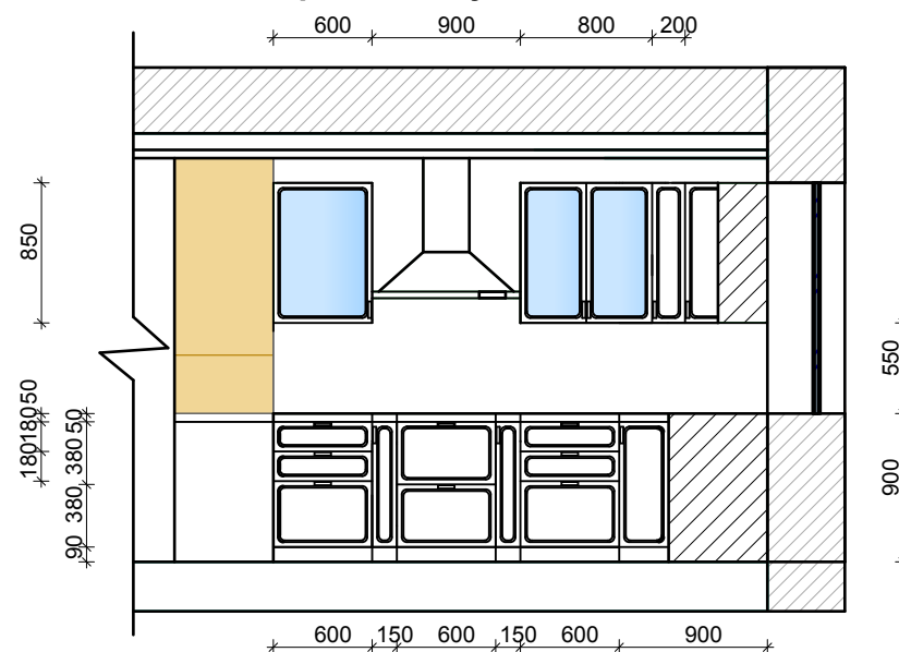
Розгортка стін кухні по осях В-А М 1:50
