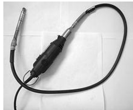
Рис.1.4 Гнучкий вал з двигуном для ювелірних робіт
