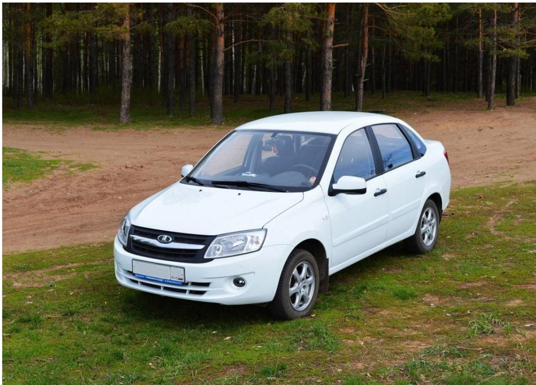
В серийное производство автомобиль пошел в 2011 году. Авто имеет три силовых агрегата – восьмиклапанный двигатель объемом 1.6 литра, мощностью 87 лошадиных сил, и два 16-клапанных мотора 1.6, мощностью 98 и 106 л.с.
