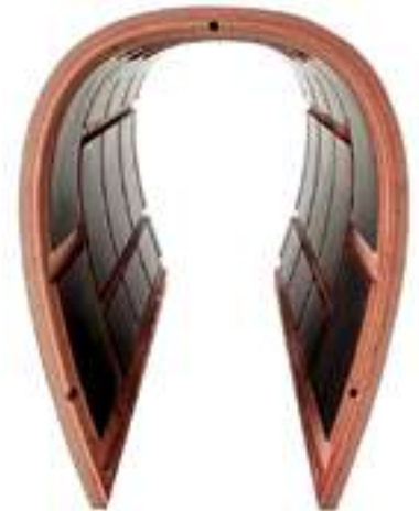
В поздовжньому розрізі корпус має форму краплі
