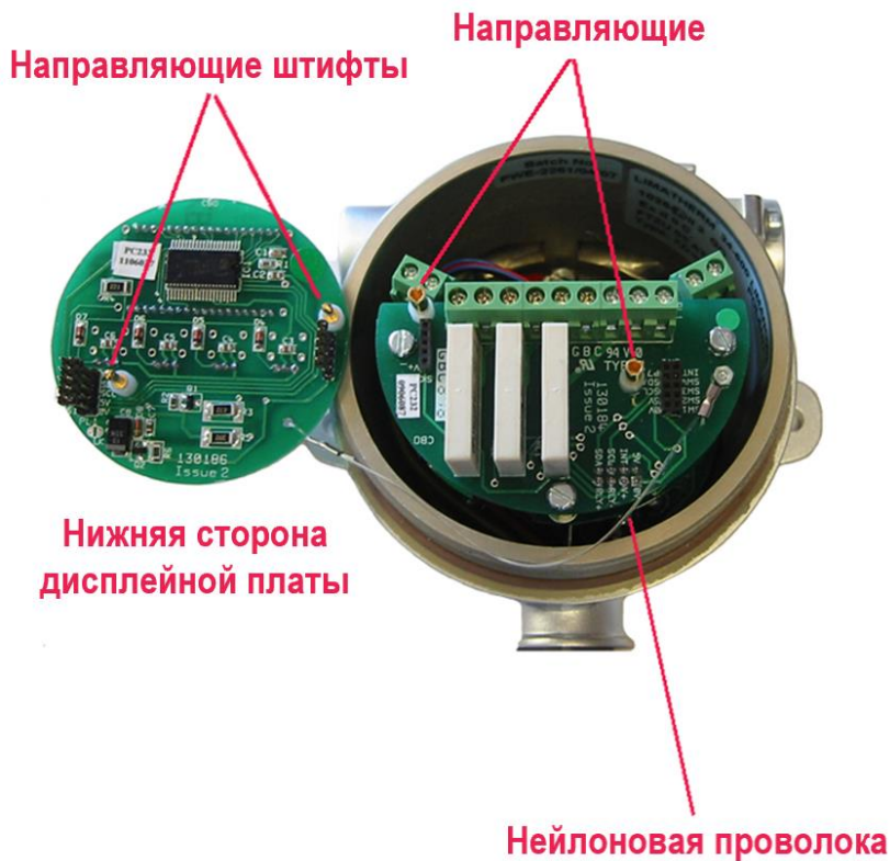
Рисунок 1. Отсоединение платы дисплея для подключения клемм
